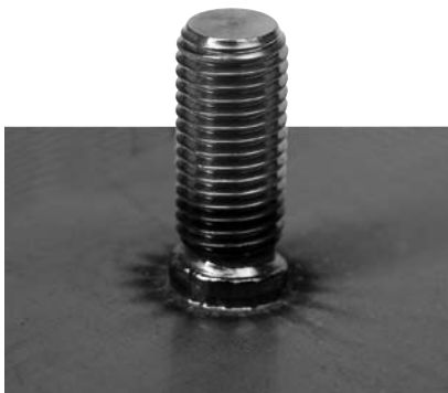
Bolzenschweißen mit Hubzündung bei Verwendung von Keramikringen
